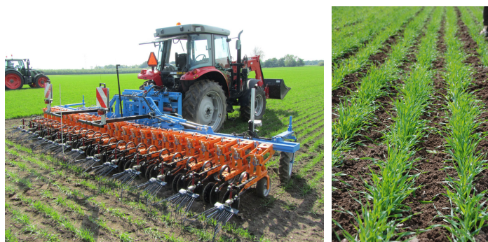
Billede 1. Radrenser opsat til radrensning af korn på 25 cm rækkeafstand. Foto: Henning Sjørlev Lyngvig og Inger Bertelsen, Videncentret for Landbrug (VFL)
