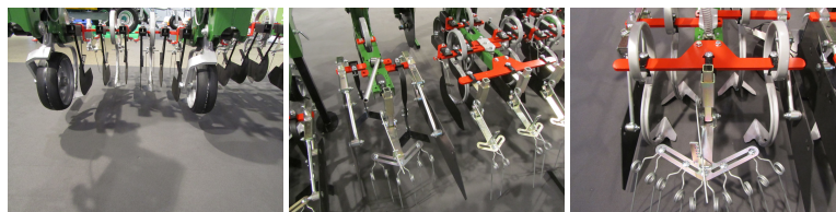
Billede 10. Skæropsætninger på 25, 50 og 75 cm på Thyregod radrenser. Foto: Henning Sjørslev Lyngvig, VFL
