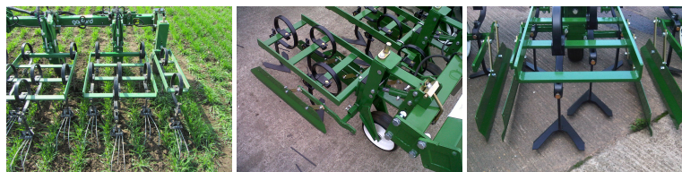
Billede 7. Skæropsætning til korn på 25 cm, roer på 50 cm og majs på 75 cm. Foto: Henning Sjørsløv Lyngvig, VFL og Garford
