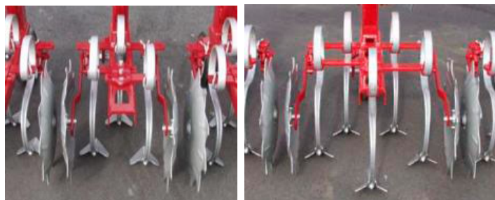
Billede 8. Skæropsætninger på 50 og 75 cm rækkeafstand på Kongskilde radrenser. Foto: Kongskilde
